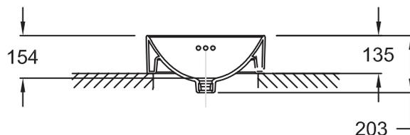
Спецификация продукта : Накладная раковина Ø 42 см. E14800. Коллекция : VOX. РАЗМЕРЫ (СМ) : 42 x 42 см. ВЕС : 8.8 кг. МАТЕРИАЛ : Огнеупорная керамика. ТИП УСТАНОВКИ : Накладные.
